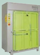
DIXI 18 S 18 tonn presskraft Ballevikt 140-220 kg
